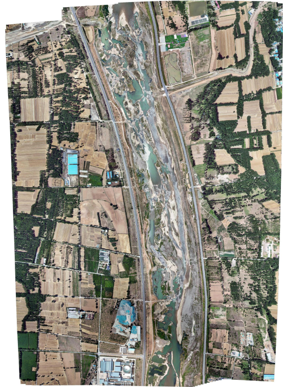
图 12. 严密空三模式下后处理拼接成果 (擎视智图)
